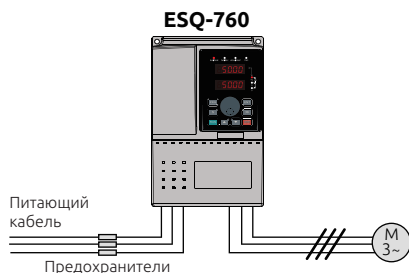
Рисунок 3-23. Схема установки предохранителей.
